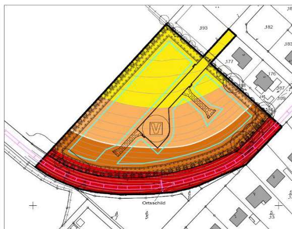
Abbildung 12: Anlage 7 Verkehrslärmgutachten, Lärmkarte Höhe 5,6 m, Quelle: ibs
